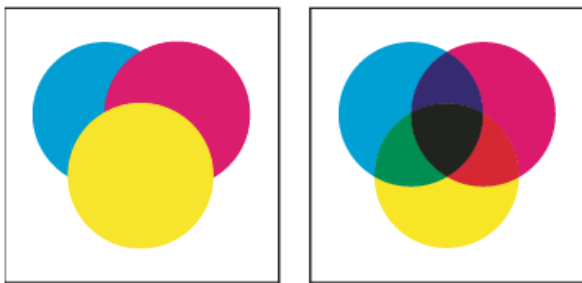
Drei überlappende Kreise ohne Überdrucken (links) und drei überlappende Kreise mit Überdrucken (rechts)
